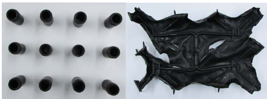
Figura 11. Gomas RB-131 y vena de inyección requerida para obtener piezas completas.
