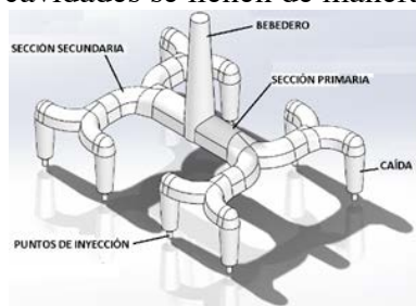
Figura 1. Partes de la vena de inyección.
